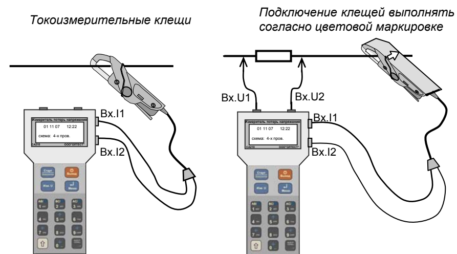
Рисунок 6.6. Подключение переносного блока Измерителя при измерении напряжения, силы тока, разности фаз, а также мощности и ее составляющих
