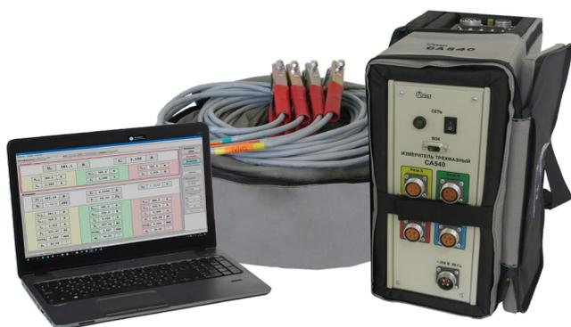
Измеритель трехфазный СА540 при использовании с ПО "Завод" предназначен для измерения характеристик силовых трансформаторов классом напряжения 0,4 кВ и 0,23 кВ на номинальном напряжении при их производстве
