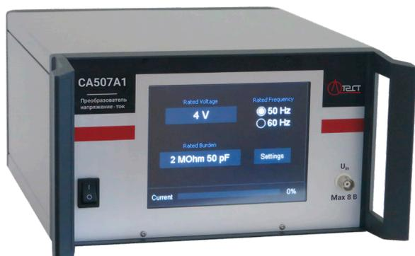
Преобразователь напряжение-ток CA507A1 позволяет расширить функциональные возможности Компаратора CA507 и других традиционных приборов сравнения для осуществления с их помощью поверки и калибровки трансформаторов тока малой мощности с аналоговым выходом в виде переменного напряжения (ТТММ).
