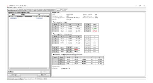
Использование ПО «СА540 Завод» существенно упрощает и ускоряет процесс испытания силовых трансформаторов. Все величины рассчитываются автоматически, программа сигнализирует о неправильном подключении оборудования и превышении заданых границ измеряемых величин, что существенно уменьшает вероятность ошибки оператора.
