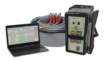
Программное обеспечение «СА540 Завод» позволяет расширить функциональные возможности измерителя трехфазного СА540 для обеспечения испытаний силовых трансформаторов на номинальном напряжении 0,4 кВ и 0,23 кВ на стороне низкого напряжения.
