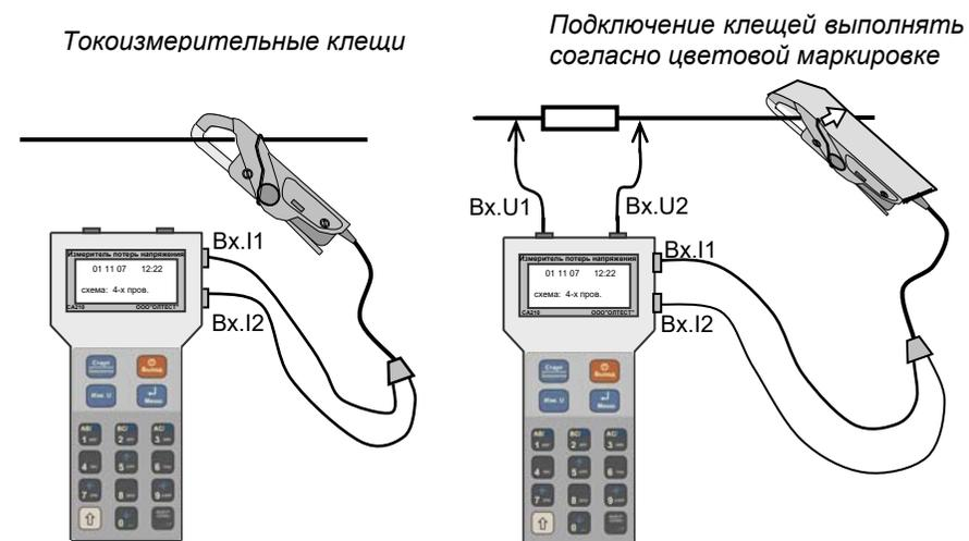
Рисунок 6.5. Подключение переносного блока Измерителя при измерении силы тока
