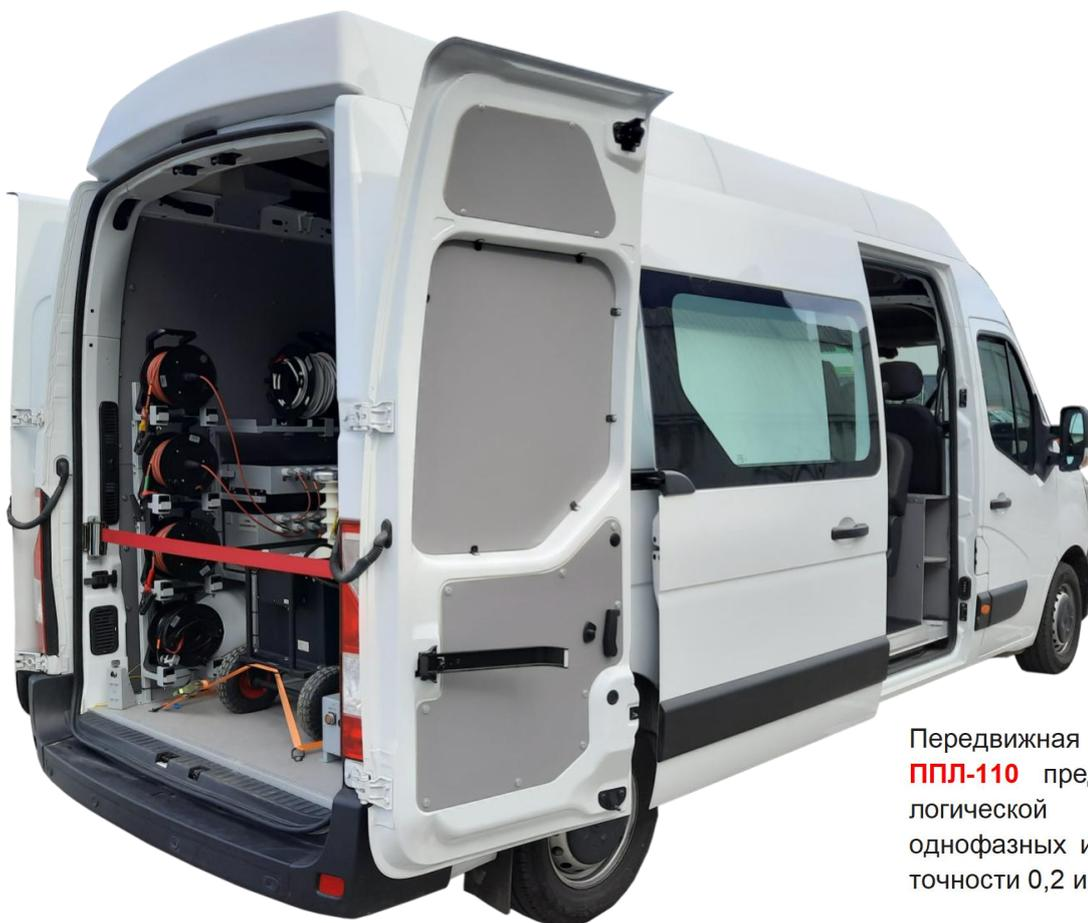
Передвижная поверочная лаборатория **ППЛ-110** предназначена для метрологической поверки (калибровки) однофазных и трехфазных ТН класса точности 0,2 и менее точных
